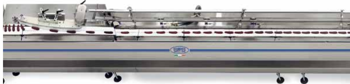
ALIMENTATORE AUTOMATICO SENZA CONTATTO Alimentatore in linea composto da una serie di nastri servo motorizzati, che garantiscono un polmone di prodotto senza "contatto" e una successiva fasatura degli stessi sulla catena di alimentazione della confezionatrice.
