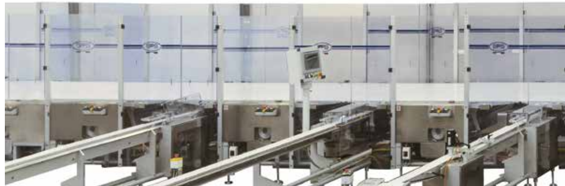
Stazioni di distribuzione ranghi per smistare file di prodotto sui vari rami di incarto
